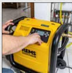
Désembouage d'installations de chauffage (S, SL, SLW)
